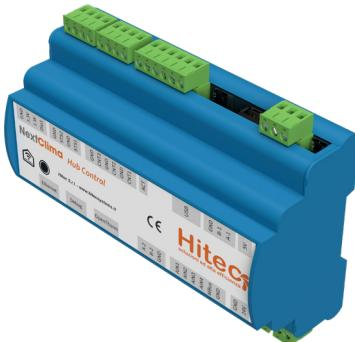
L'unità di regolazione evoluta per impianti radianti e trattamento dell'aria offre una gestione semplice e precisa dei parametri ambientali da PC e smartphone. Controlla la temperatura e l'umidità relativa in zone indipendenti, permette una programmazione oraria avanzata e gestisce in modo avanzato la centrale termica.
