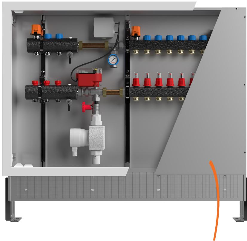
Cassetta di contenimento costruita in lamiera zincata, con piedini regolabili, telaio e porta metallica bianca, dotata di staffe di fissaggio collettori e coperchio di protezione per intonaci metallico. Larghezza di 85/100/115 cm e spessore 12 cm.
