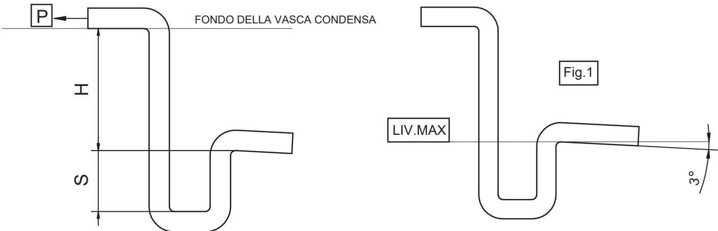
P = somma delle perdite di carico a monte del ventilatore (filtri, scambiatore, distribuzione)
