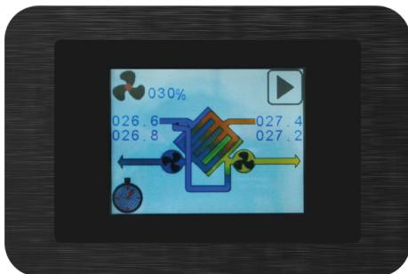
Il pannello di controllo touch screen è stato progettato per gestire unità di Ventilazione Meccanica Controllata con Recupero di Calore in modo semplice e intuitivo. L'utente interagisce col controllo tramite le icone del display grafico touch. La finestra principale è una rappresentazione grafica dettagliata dello stato della macchina dalla quale è possibile attivare le funzioni disponibili.
