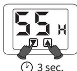
Vengono proposte in successione le voci del menù. Per ognuna viene visualizzata la sigla identificativa seguita dal lampeggio del relativo valore. Usare i tasti ▲ ▼ per modificare il valore. Il passaggio al parametro successivo avviene trascorsi 3 secondi senza la pressione di alcun tasto. Una volta impostati tutti i parametri viene visualizzata la scritta END e l'umidostato torna al normale funzionamento salvando le modifiche apportate.
