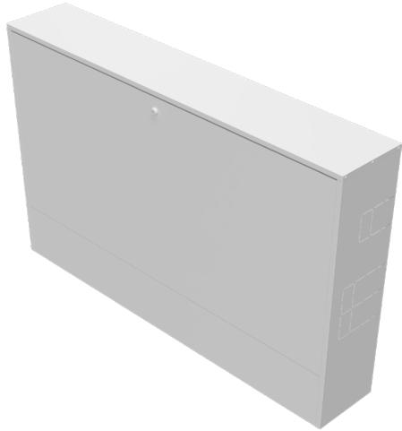
Armadietto per esterni costruito in acciaio verniciato a polveri con schienale aperto per posizionamento a impianto finito, falsi fori per entrate laterali, porta metallica bianca verniciata a polveri con serratura. Possibilità di alimentazione da entrambi i lati. Per collettori Hitec Alta Portata 1" 1/4 e Hitec Tecno Inox 2".
