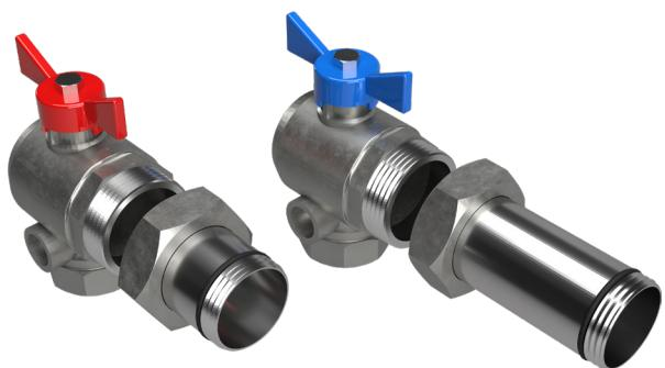
Coppia valvole a sfera ad angolo a passaggio totale Ø 1" con bocchettone, codolo maggiorato e maniglie a farfalla rosse e blu, tenuta O-Ring lato collettore, disassate 36 mm. Predisposte per inserimento termometro.
