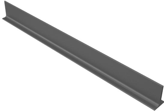
Giunto di dilatazione con base adesiva prodotto in polietilene espanso. Ottimale per il posizionamento sulle porte o quando si deve interrompere un massetto per garantire la dilatazione. Adesivizzato sulla parte inferiore.
