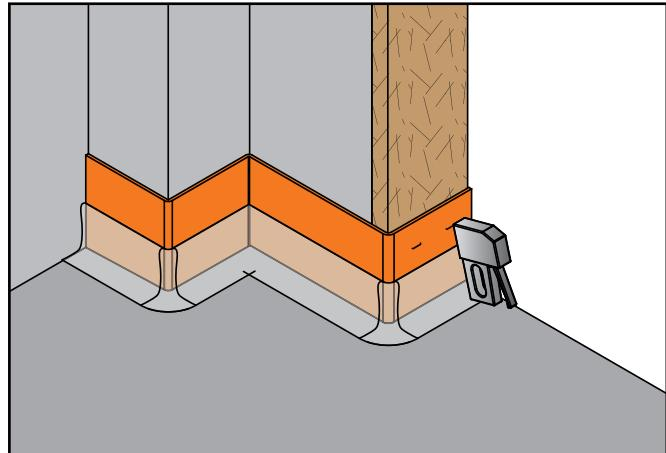
**Prima della posa del pannello isolante**, per garantire la dilatazione del massetto e del pavimento, deve essere installata la fascia Sticker lungo i muri perimetrali e lungo tutti i componenti edilizi verticali che penetrano nel pannello isolante (colonne, scale, caminetti, piatti doccia ecc.); la fascia perimetrale deve essere saldamente fissata alla superficie verticale, ad esempio a telai delle porte, montanti e pilastri.
