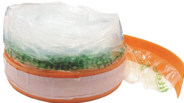
Fascia perimetrale Hitec STICKER per assorbimento delle dilatazioni del pavimento. Realizzata in polietilene espanso a struttura cellulare chiusa, dotata di banda autoadesiva su un lato e di foglio in polietilene accoppiato per evitare infiltrazioni del massetto tra fascia e pannello.
