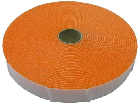
Fascia perimetrale Hitec Sticker Special per assorbimento delle dilatazioni del pavimento. Realizzata in polietilene espanso a struttura cellulare chiusa, dotata di banda autoadesiva su un lato e di foglio in polietilene accoppiato per evitare infiltrazioni del massetto tra fascia e pannello.
