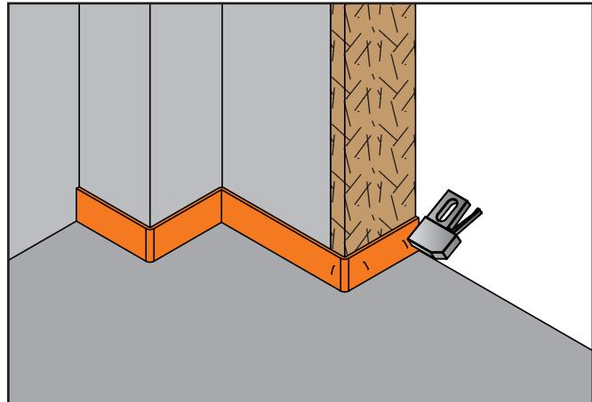
**Prima della posa del pannello isolante**, per garantire la dilatazione del massetto e del pavimento, deve essere installata la fascia Sticker Special lungo i muri perimetrali e lungo tutti i componenti edilizi verticali che penetrano nel pannello isolante (colonne, scale, caminetti, piatti doccia ecc.); la fascia perimetrale deve essere saldamente fissata alla superficie verticale, ad esempio a telai delle porte, montanti e pilastri.
