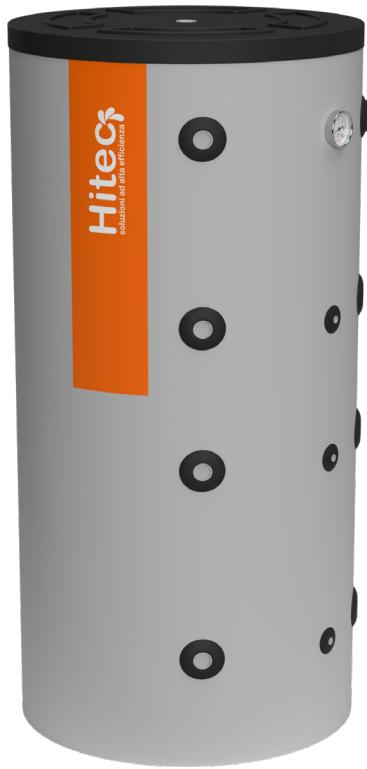
Accumulo verticale, a basamento, costruito in acciaio al carbonio S235JR, trattato esternamente con vernice antiruggine. Utilizzabile come volano termico e adatto allo stoccaggio di acqua tecnica calda o fredda (refrigerata), può essere alimentato sia da caldaie o termocucine sia da pompe di calore o gruppi frigo.
