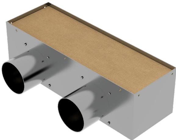
Adattatore con doppio attacco per condotto flessibile circolare DN 75 in lamiera zincata. Costruito a spessore ridotto per inserimento nelle pareti in cartongesso spessore 75 mm. Fornito con protezione intonaco.
