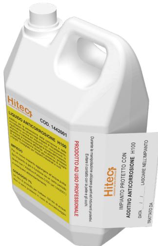
Additivo per la prevenzione della corrosione e delle incrostazioni negli impianti di riscaldamento. Applicabile anche ad impianti con componenti in alluminio. Elimina i problemi di mancata circolazione dovuti alla presenza di scaglie, fanghi e residui di lavorazione. Tiene sotto controllo la crescita microbiologica di alghe e funghi. Adatto a tutti gli impianti. Compatibile con tutti i metalli (alluminio incluso) e materiali utilizzati negli impianti di riscaldamento e raffrescamento.
