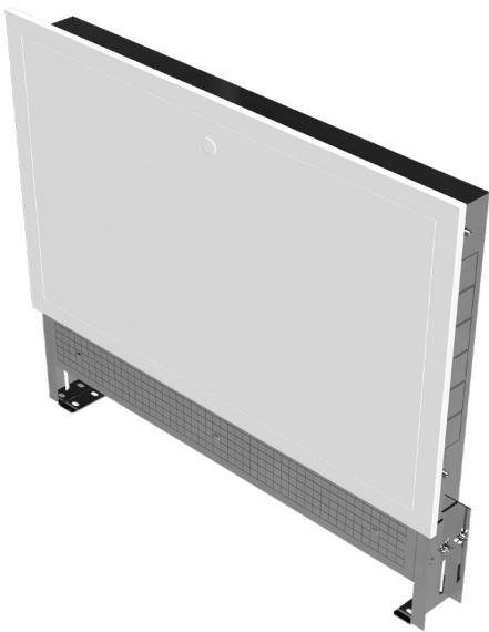
Armadietto costruito in lamiera zincata, con piedini regolabili, falsi fori per entrate laterali, guide per fissaggio collettori. Telaio e porta metallica bianca, per installazione a filo muro, serratura a cacciavite, coperchio di protezione per intonaco metallico, alzatina inferiore.
