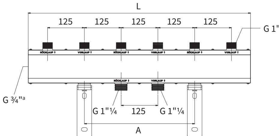
**a:** connessione per vaso di espansione e/o valvola di scarico.
