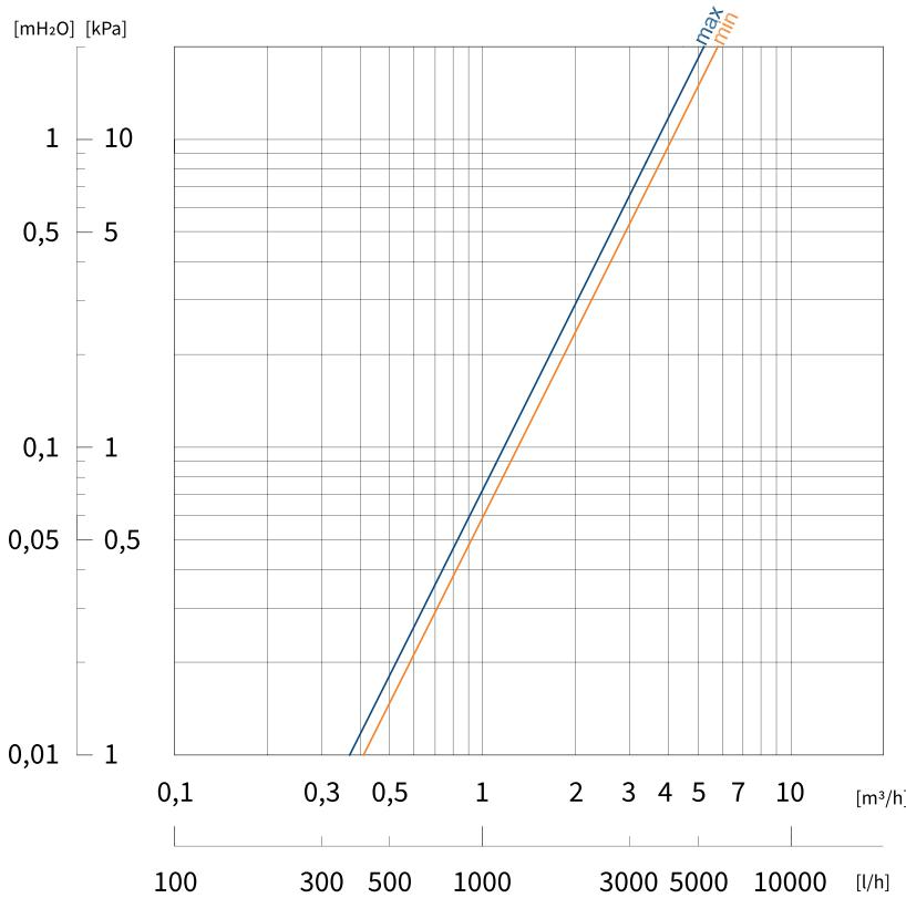
**MAX:** la retta indica la condizione di massima perdita di carico di un singolo modulo, corrispondente alle posizioni più esterne del collettore.
