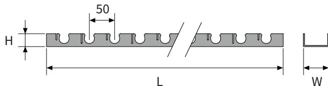
Barra per fissaggio tubazione Hitec PE-Xa Ø 20 mm e Ø 25 mm, per sistemi industriali con barra binario.
