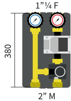
I moduli DN 25 vengono forniti nella configurazione con attacchi 1" F - 1" F. Rimuovendo i raccordi posti sugli attacchi inferiori è possibile ottenere la configurazione 1" F - 1" 1/2 M.
