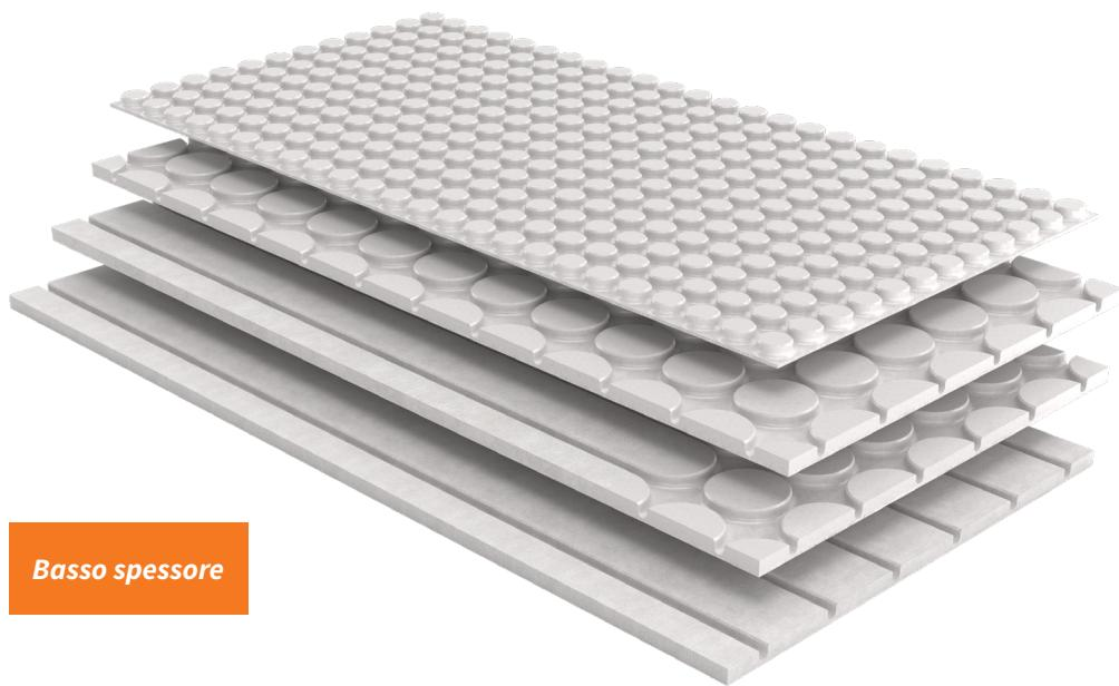
Pannelli in gessofibra, di 18 mm di spessore, fresati per contenere le tubazioni in PE-Xa Ø 12 mm con barriera antiossigeno. I pannelli sono disponibili nella dimensione 1200 x 600 [mm] in 4 diverse trame di fresatura. Il pavimento può essere posato
