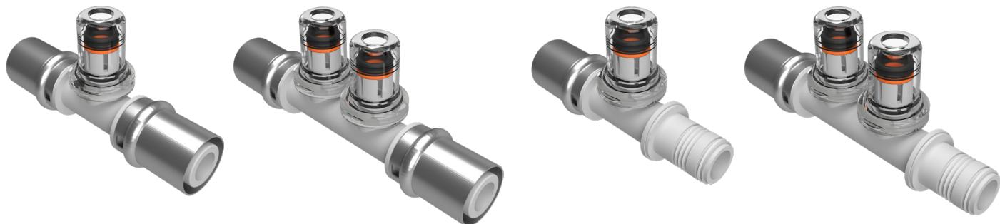
Raccordi di distribuzione Grey-Evo con 1 o 2 uscite dotati di tecnologia ad innesto rapido sul Ø 8 mm e innesto a pressare sui Ø 20, per il collegamento della tubazione in Pe-Xc/al/Pe-Xc 20x2 a quella dei pannelli radianti in PE-RT 8x1. Il corpo in materiale plastico trasparente permette di verificare il corretto innesto della tubazione Ø 8 mm. Nei raccordi “terminale” l'estremità priva di bussola è chiusa per l'interruzione del circuito.
