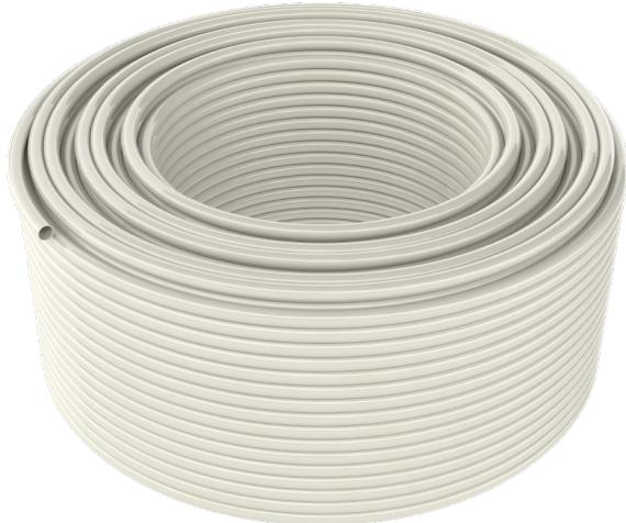
Tubo Hitec EVO-Pipe Ø 17 in polietilene resistente alle alte temperature (PE-RT tipo II), adatto all'utilizzo nei sistemi di riscaldamento e raffrescamento radianti, conforme a normativa ISO 22391, con barriera antiossigeno EVOH secondo normativa DIN 4726.
