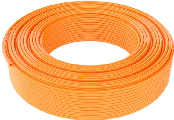
Tubo Hitec PE-Xa Ø 12 in polietilene ad alta densità reticolato con sistema di tipo "A", adatto all'utilizzo nei sistemi di riscaldamento e raffrescamento radianti, conforme a normativa ISO 15875. Dotato di barriera antiossigeno EVOH secondo normativa DIN 4726. Garanzia di reticolazione omogenea e permanentemente stabile senza rischio di discontinuità per il mantenimento delle caratteristiche nel tempo.
