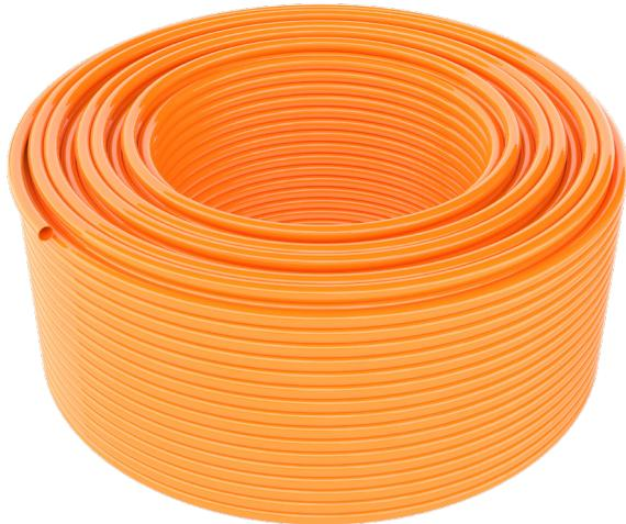
Tubo Hitec PE-Xa Ø 17 in polietilene ad alta densità reticolato con sistema di tipo "A", adatto all'utilizzo nei sistemi di riscaldamento e raffrescamento radianti, conforme a normativa ISO 15875. Dotato di barriera antiossigeno EVOH secondo normativa DIN 4726. Garanzia di reticolazione omogenea e permanentemente stabile senza rischio di discontinuità per il mantenimento delle caratteristiche nel tempo.
