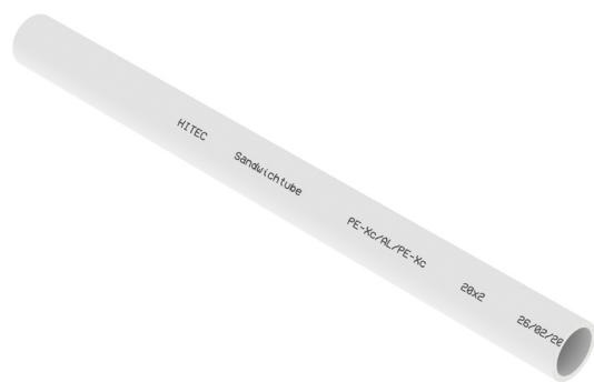
Tubo multistrato Hitec composto da uno strato in alluminio saldato longitudinalmente testa a testa, ricoperto all'interno e all'esterno da polietilene ad alta densità reticolato tramite bombardamento di elettroni. I diversi strati sono resi solidali mediante speciali componenti leganti. Il processo di reticolazione dello strato interno ed esterno migliora ulteriormente le qualità naturali del polietilene, con notevoli vantaggi sulla resistenza alla pressione e alle alte temperature.
