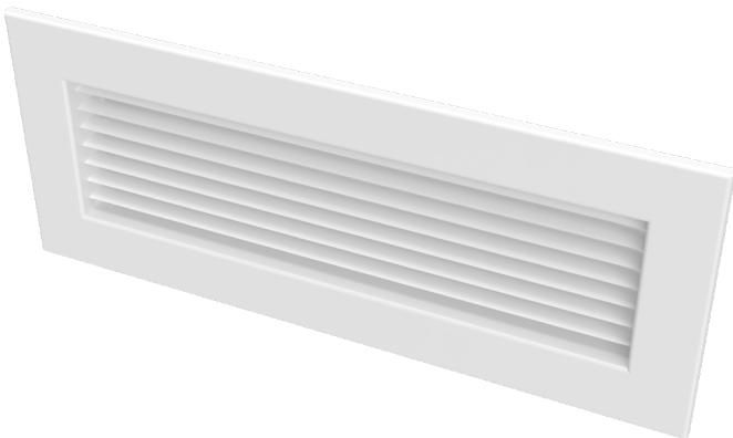
Griglia a feritoie realizzata in PVC anticondensa bianco RAL 9010 a singolo ordine di 7 alette orientabili individualmente. Fissaggio standard con n. 4 clips.
