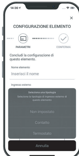
Fig.4 Attribuire un nome all'elemento. Selezionare la modalità di funzionamento dell'ingresso ausiliario: NON IMPOSTATO. Per le altre modalità consultare il manuale.
