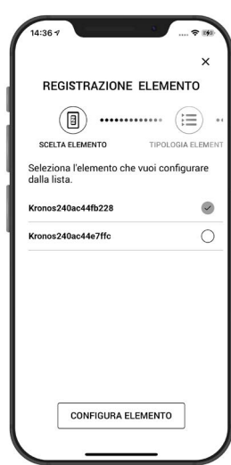
Fig.7 Attivare il BLE di Kronos TA (vedi sez. 11). Selezionare l'elemento che si desidera configurare tramite Bluetooth.
