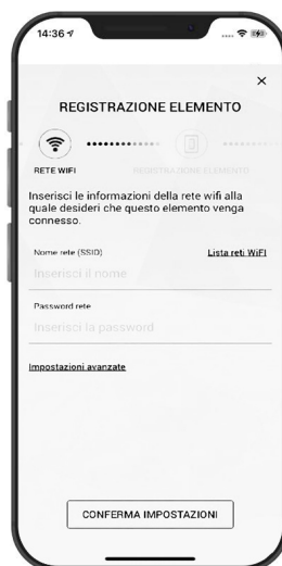
Fig.8 Fare tap su REGISTRA ELEMENTO. Inserire il nome della rete (SSID) e la password. Confermare le impostazioni e attendere la conclusione della registrazione.
