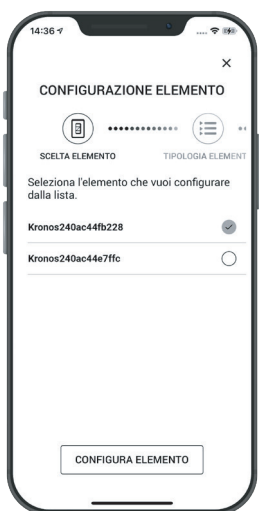
Fig.2 Attivare il BLE di Kronos TA (vedi sez. 11). Selezionare l'elemento che si desidera configurare tramite Bluetooth.
