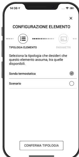
Fig.3 Selezionare la modalità Sonda Termostatica. Attenzione: modalità Scenario non supportata.
