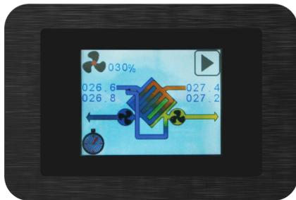
Il pannello di controllo touch screen è stato progettato per gestire unità di Ventilazione Meccanica Controllata con Recupero di Calore (VMC-RC) in modo semplice e intuitivo. L'utente interagisce col controllo tramite le icone del display grafico touch. La finestra principale è una rappresentazione grafica dettagliata dello stato della macchina dalla quale è possibile attivare le funzioni disponibili.
